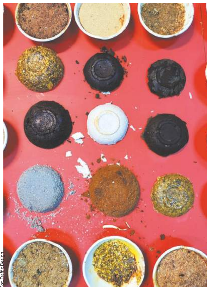
Próbki materiałów do biotynku
